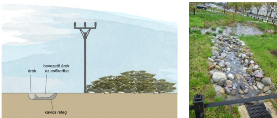
42. ábra: Kálvári-domb déli oldalán javasolt vízmegtartó megoldás metszete és előképe
