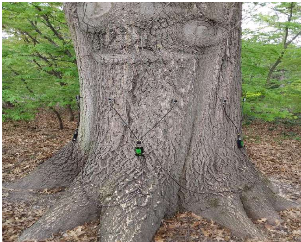
2. ábra ArborSonic 3D akusztikus tomográf Quercus palustris (17.) törzsén
